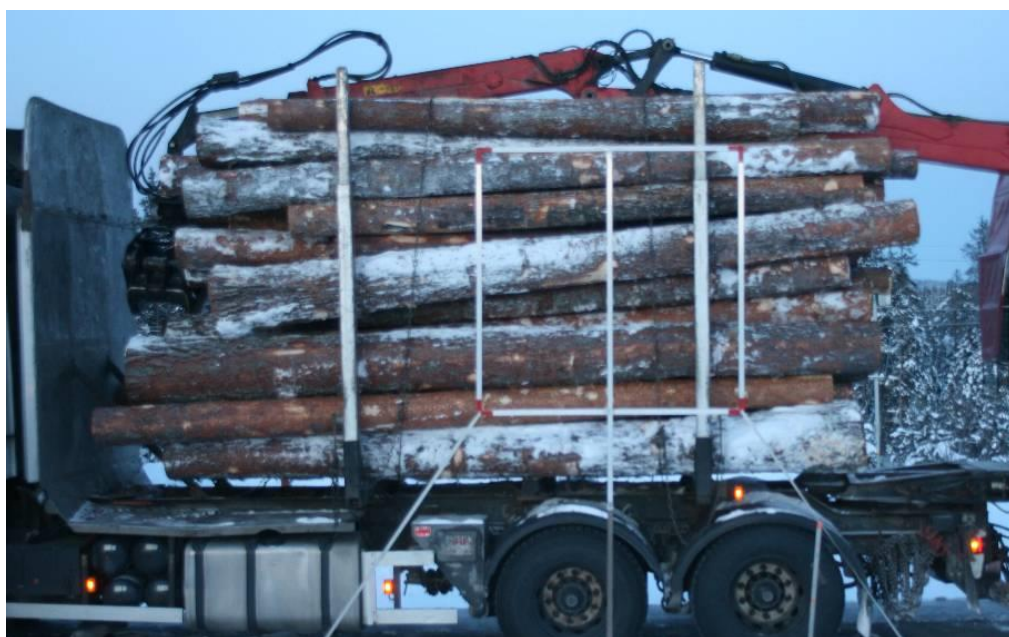
Figur 22. Trave 7. Överskattad vedlängd, vedvolym% och lastbredd. Underskattad höjd.
