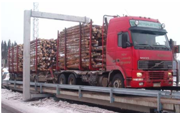
Figur 7. Travmätning med laserteknik. Finska Codator Oys anläggning i Simpele i sydöstra Finland.
