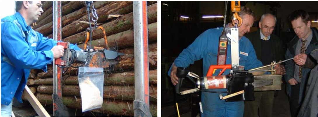
Figur 2. Torrhaltsprovtagning med kedjefräs vid Stora Enso, Maxau i Tyskland samt studie av senaste version av kedjefräsen hos firma Ritter.
