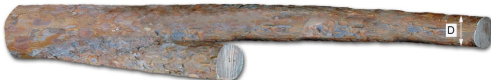
Figur 4. Mätning av stock med klyka. Det kortare klykbenet når här kortare än halva stocklängden (mätt från roten) varför korrekt diameter är D .
