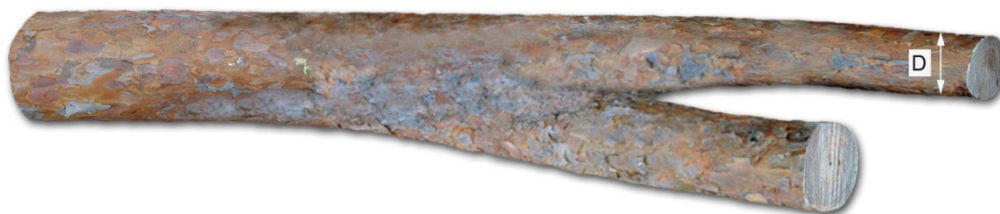
Figur 3. Mätning av stock med klyka. Det kortare klykbenet når här längre än halva stocklängden (mätt från roten) varför korrekt diameter är D + D/3 .
