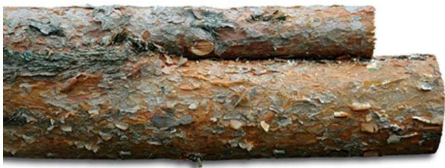
Figur 3. Sluten klyka, ingen luft mellan klykbenet och huvudstammen.
