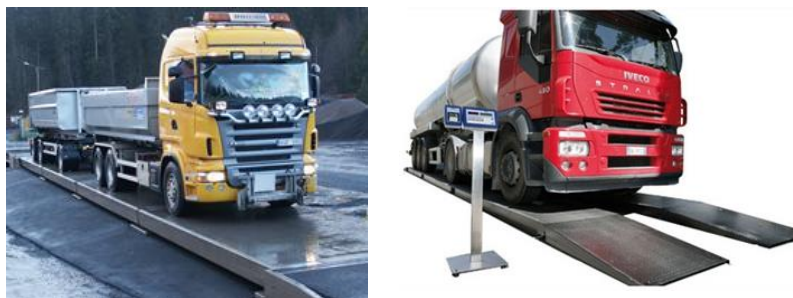
Figur 1. 24-m statiska fordonsvågar (t.v. Flintab med tre vågplattor, t.h. Vetek med dubbla körbanor).
