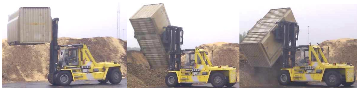
Figur 8. Lossningstruck vid Nykvarn utrustad med Loadmaster 9000i.
