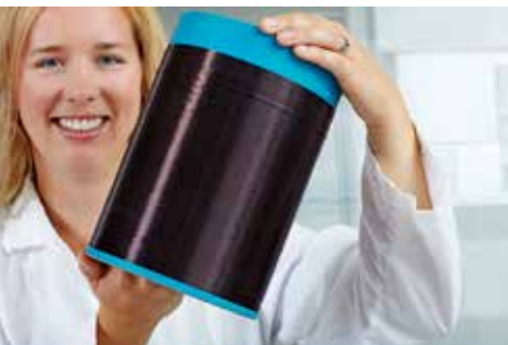
Hannah Schweinebarth Innventia med en spole ligninfiber spunnen i multifilamentextruder
