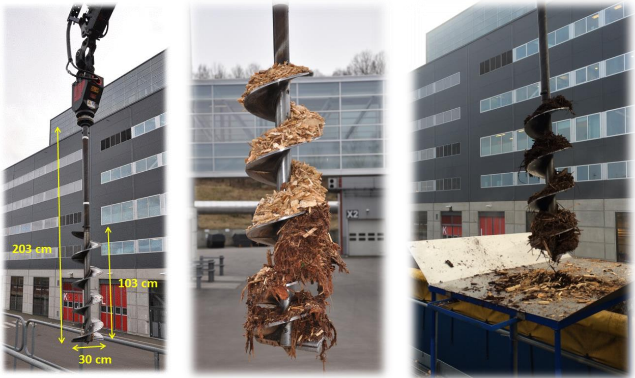
Figur 2. Borrens dimensioner (vänster), resultatet av en borrhning i en skäppa (mitten), samt ett borrhprov över tömningsbordet, där redan ett borrhprov tömts (höger). I både mittenbilden och bilden till höger så har skäppans last bestått av en blandning av bark och stamvedsflis, där barken legat i botten av skäppan. Foto: Hans Fryk och Sven Gustafsson
